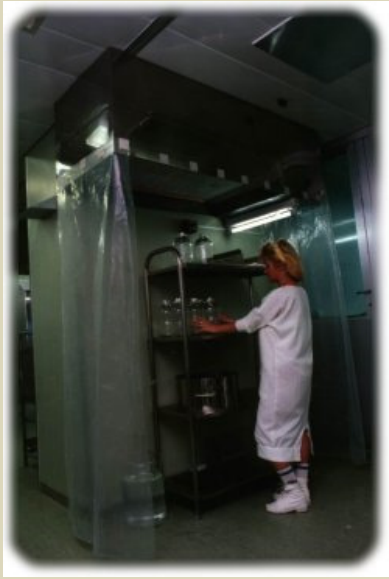
BV-1200 típusú lamináris box függőleges levegőáramlással kiserelési munkákhoz 100-as tisztatér az US209/E előírásának megfelelően
