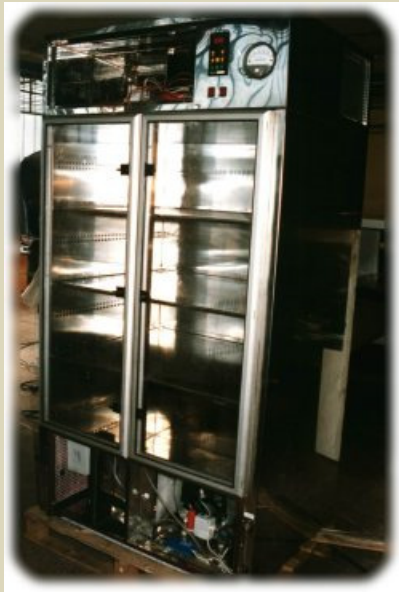
KAT F-SZ-1000 típusú klimatizált munkaterű kisállattartó box
