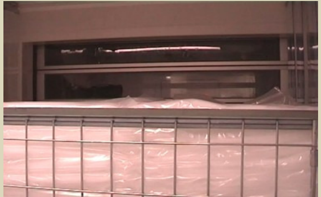
Anyagátadó zsillip visszaállási idő mérése, letisztulási szintje
