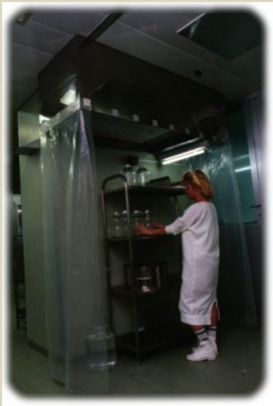
BV-1200 típusú lamináris box függőleges levegőáramlással készítési munkákhoz 100-as tisztatér az US209/E előírásá- nak megfelelően
