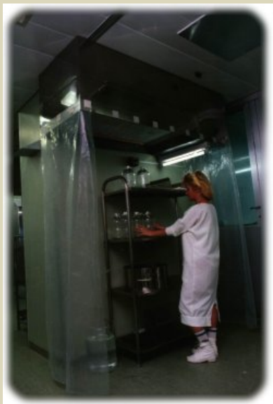
BV-1200 típusú lamináris box függőleges levegőáramlással kiszereleési munkákhoz 100-as tisztatér az US209/E előírásának megfelelően
