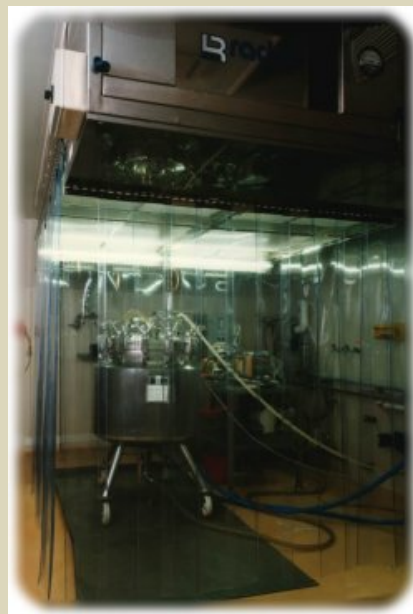
BV-2400x2400 típusú függőleges levegőáramlású laminaris box, rozsdamentes kivitel 100-as tisztatér az US209/E előírásának megfelelően
