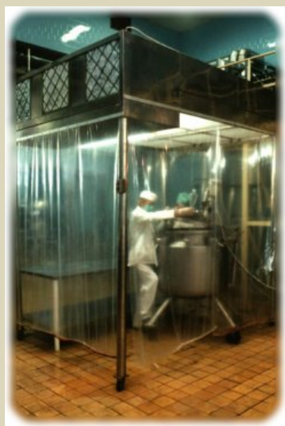
BV-1800 x 1800 függőleges levegőáramlású rozsdamentes kivitelű, 100-as légterű mozgatható lamináris box
