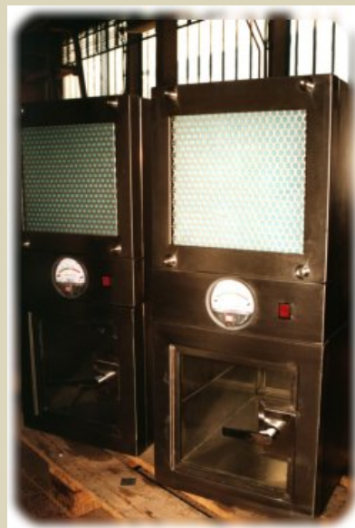
ZS-305 típusú átadózsilip Nagy tisztaságú, tiszta- és fekete tér elválasztására alkalmas rozsdamentes átadózsilip belső levegőáramlást biztosító ventilátorral
